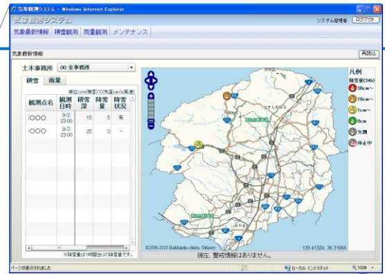
▲ 積雪情報表示画面(地図表示) 各地に設置した積雪センサーで観測したデータを一覧のほか、地図上でも確認できます。
